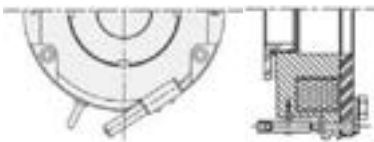
WFA/WFB/WFC Mikroschalter zur Überwachung des Luftspalts
